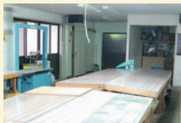
↑荷造り出荷場のレイアウト。手前：切り花の調製束づくり台、右奥：鮮度保持前処理・荷造り室、左奥扉：調製用冷蔵庫、左手前：梱包機。
